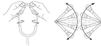
耳管は角度調整が可能。外耳道の角度に合わせてすることで、音の減衰を防ぎます。
