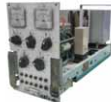
製鉄工場内 サイリスタ制御用ユニット
